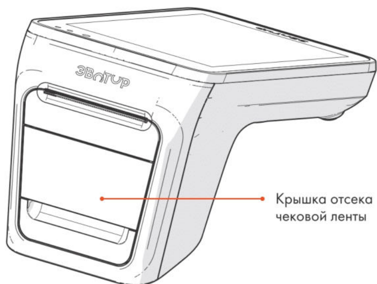
Рисунок 4. Доступ к отсеку чековой ленты
